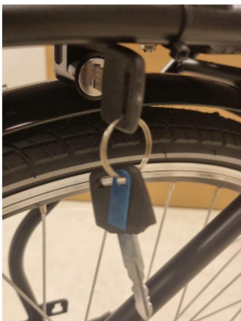
Lås upp batterispärren med nyckeln.
