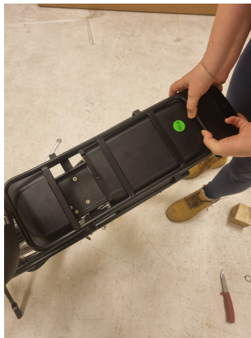
Dra ut batteriet efter du låst upp spärren.
