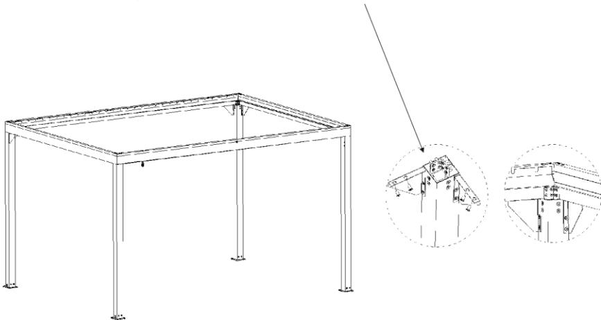
OBS! Se till att alla 4 stolparna sitter rakt, annars blir monteringen av hängrännorna svår. Du kan ev. behöva lossa skruvar vid konsolerna för att få hängrännorna på plats. Om detta behövs, glöm inte att dra åt skruvarna igen innan du fortsätter.
